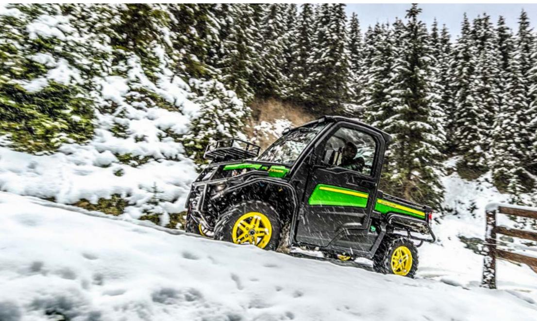
(17 kW) ausgestattet. Die Servolenkung gehört zur Standardausstattung dieses Fahrzeugs, das auch mit einem 4x4 Antrieb ausgerüstet ist und zwei stufenlose Geschwindigkeitsbereiche aufweist. Die Brücke hat ein Volumen von 460 Liter und ist für eine Höchstlast von 454 kg konzipiert.
