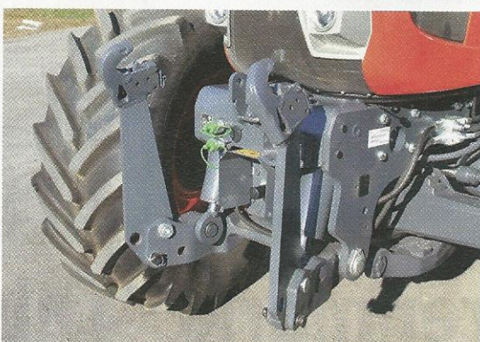
Fronthydraulik und Frontzapfwelle stammen von Zuidberg.
