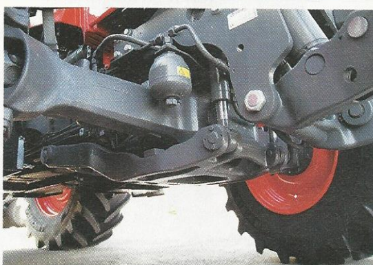
Die Vorderachsfederung lässt sich in drei Stufen den Bedingungen anpassen.
