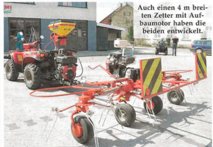
Ein hinten aufgebauter Motor mit 18 PS sorgt für den Antrieb der Anbaugeräte.
