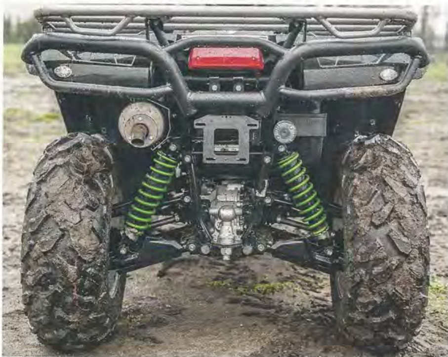
Einzelradaufhängung: Obligatorisch bei den großen ATVs. Federung ist 5-fach verstellbar.
