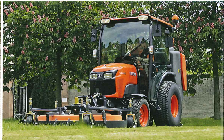
STW-Baureihe Kommunaltraktoren mit 34 bis 39 PS Motorleistung, mit Ausrüstung für die Grünflächenpflege.
