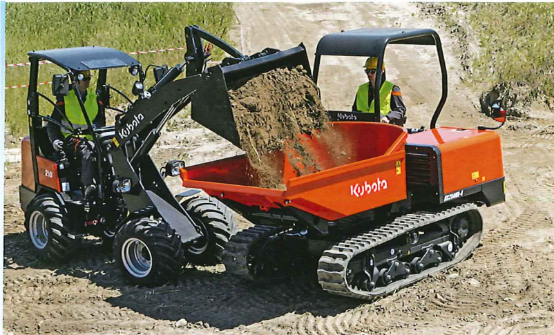
Kubotas kompakte Erdbewegungstechnik umfasst Radlader & Raupen-Dumper, Kleinbagger und Skidsteerlader. Im Bild: Kubota Radlader belädt Kubota Dumper.
