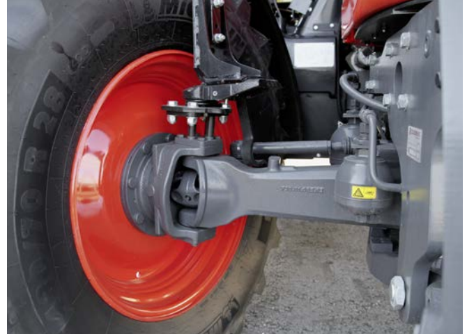
Die Vorderachse mit der Längsschwingenfederung stammt von Dana.
