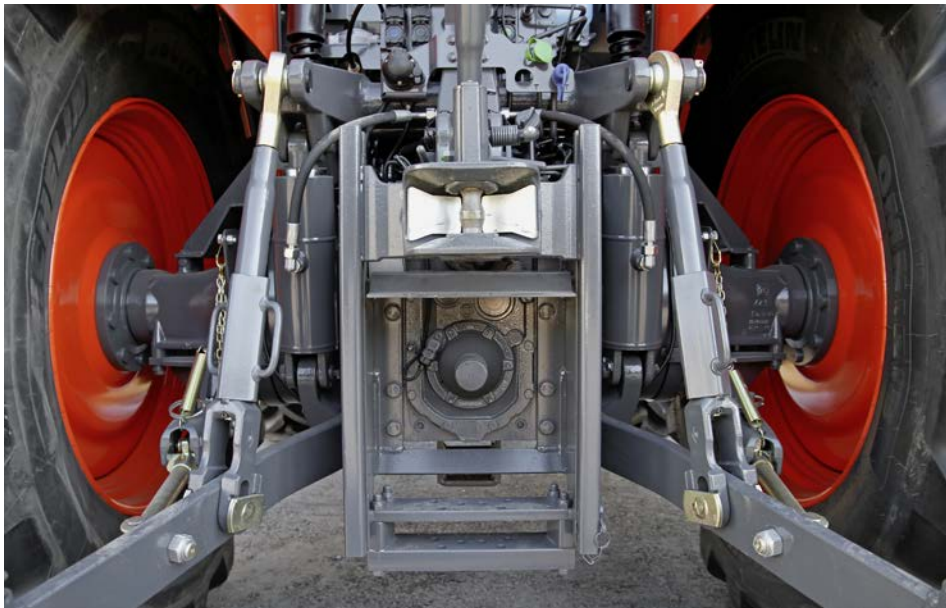
Heck der Premium-Variante: pneumatische Kabinenfederung, serienmässige Druckluftanlage, elektrische Steuergeräte und Isobus-Stecker.
