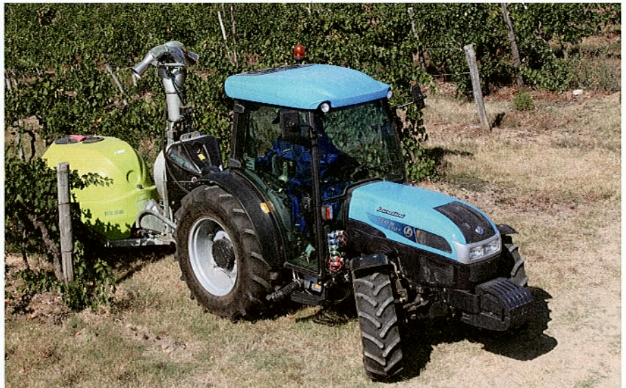
In Obstkulturen ist neben einer guten Beweglichkeit ein guter Fahrerschutz gefordert, der den Fahrer vor Sprühnebel schützt. (Werkbild)
