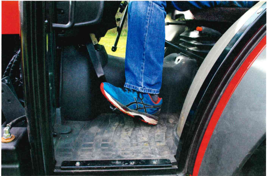
Der MF «3708 WF» war der kompakteste Traktor im Test. Dafür muss man aber mit einem Getriebetunnel vorliebnehmen.
