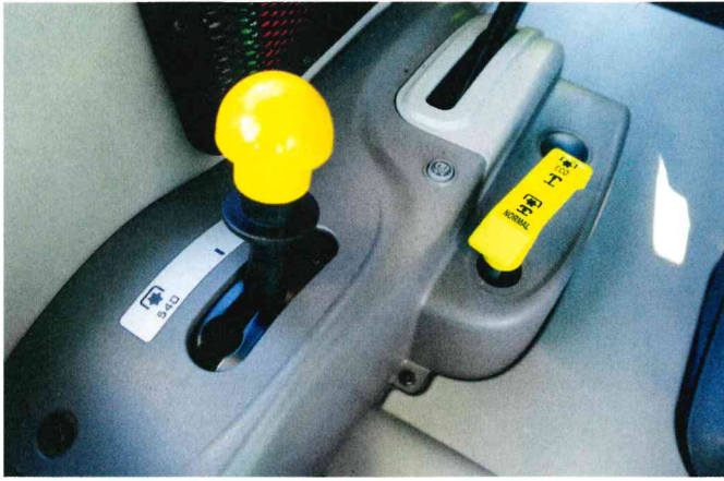
Vier Zapfwellendrehzahlen gibt es nur beim Deutz-Fahr «5080G» (Bild) und beim Lindner «Geotrac 74ep».
