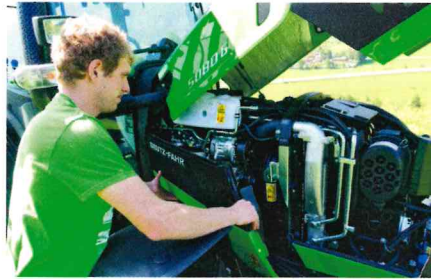
Nur der 3-Zylinder-Deutz-Motor erfüllt die Abgasstufe 3b ohne Dieselpartikelfilter.
