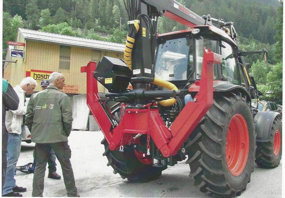
Ad. Bachmann zeigt einen Kubota-Traktor mit starrem, am Dreipunkt angebautem Holzkran von Farmi.
