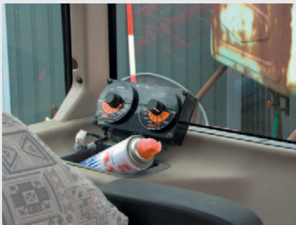
In der Kabine können die eingestellten Spurbreiten abgelesen werden.
