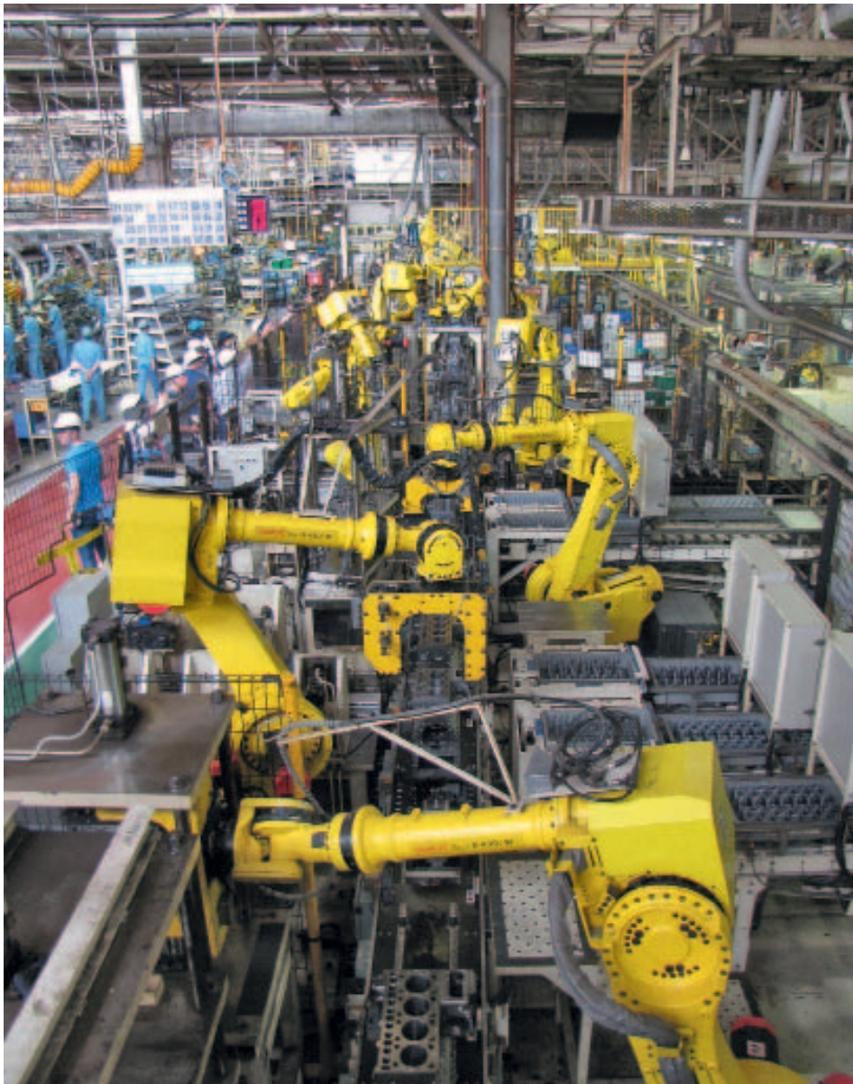
30 Roboter montieren in Tsukuba die Dieselmotoren. (Bilder: Ruedi Burkhalter)
