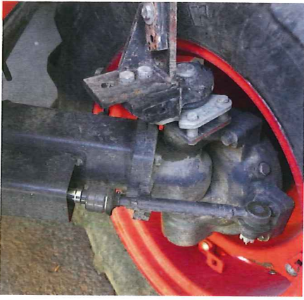
Die Wendigkeit des «M135GX» von unter sechs Metern Wenderadius wird dank des doppelten Kegelradantriebs ermöglicht.
