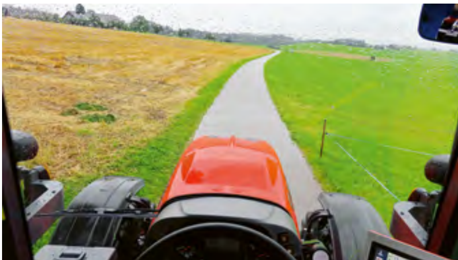
Die hochgezogene Motorhaube nimmt etwas die Sicht nach vorne, jedoch ist die 4-Pfosten-Kabine mit dem Glasdachfenster schön hell und bietet eine gute Rundumsicht.
