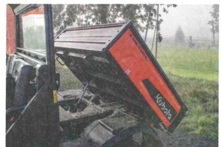
▲ Alle Achtung: Die Ladefläche ist 90 Grad kippbar und buckett bis zu einer halben Tonne.
