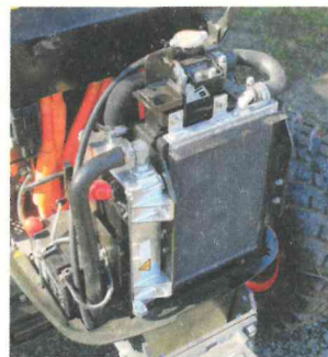
▲ Der Lithium-Ionen-Akku entspricht der 26-PS-Klasse für Kommunaltraktoren.
