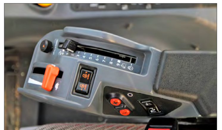
An der Armlehne kann das Hubwerk, die Motordrehzahl und das Getriebe bedient werden.
