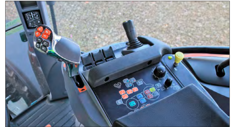
Topbedienung mit Folientastatur und Multifunktionshebel.
