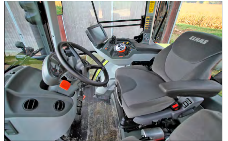
Die Kabine des Claas Arion bietet als einzige eine 4-Punkte-Federung, das erhöht den Komfort. (Bilder: Christian Leitner)
