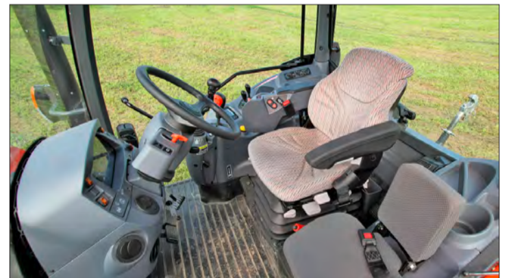
Die Kabine des Kubotas ist soweit gut, leider fehlt ihr jedoch eine Kabinenfederung. (Bilder: Christian Leitner)
