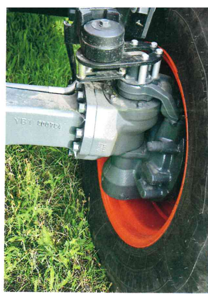
△ Hoher Einschlag dank Allradantrieb über Portalvorderachse mit doppeltem Kegelrad.
