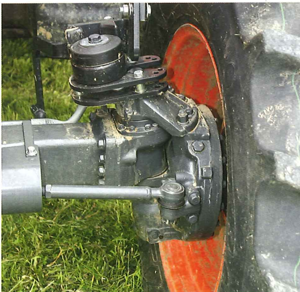
Dank dem doppelten Kegelradantrieb bietet die Vorderachse viel Bodenfreiheit und Lenkeinschlag.
