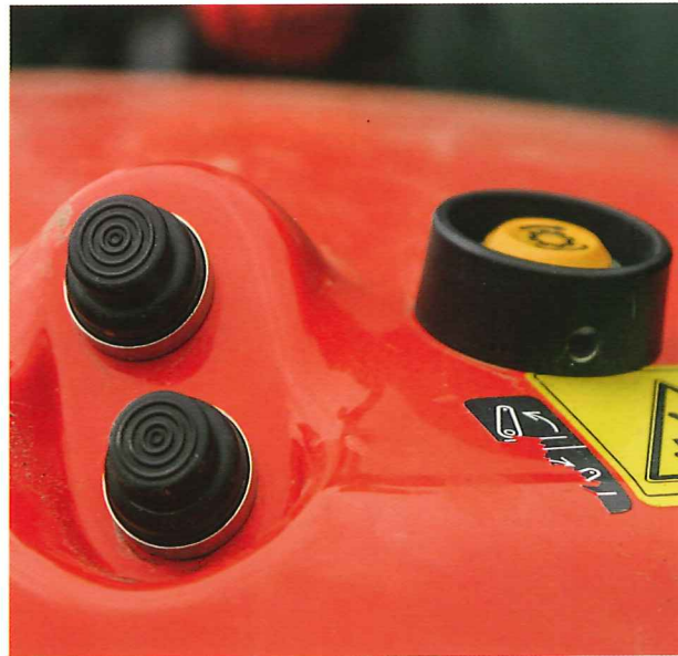
Das Hubwerk kann an beiden Kotflügeln bedient werden. Ein Knopf für die Zapfwelle gibt es auf der rechten Seite.
