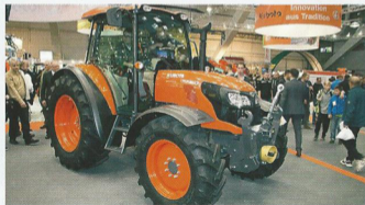
Der M9960 mit 106 PS verfügt über ein Lastschaltgetriebe.
