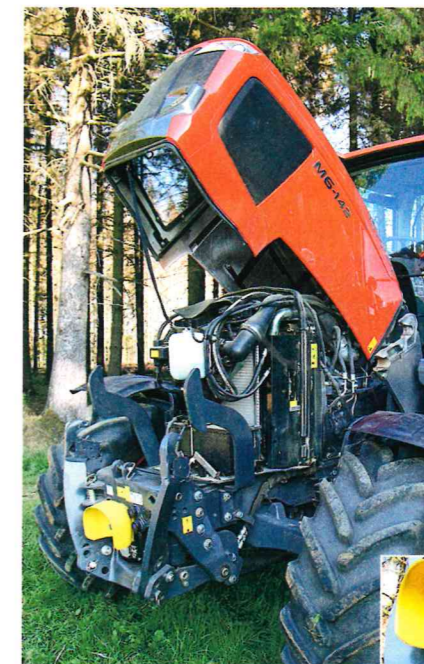
Unter der Haube sitzt der bekannte Vierzylinder mit gewaltigen 6,1 l Hubraum.
