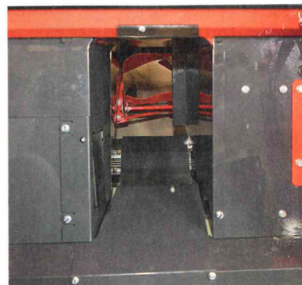
Der große Wurfkanal mit zwei Klappen zur Störungsbeseitigung von außen ist bis heute mustergültig für Mäher dieser Klasse.
