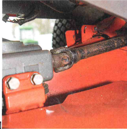
Der Primärtrieb des Mähdecks per Kardan ist wenig problematisch – will aber regelmäßig geschmiert sein!
