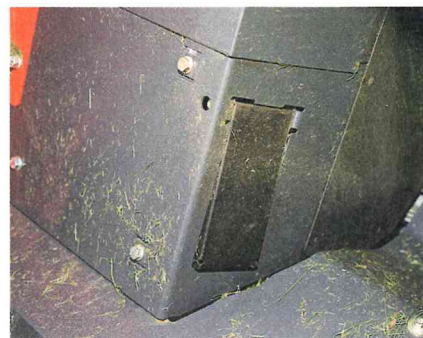
Bis 2010 bestimmte eine Membran (oberes Foto) im Wurfkanal den Füllstand im Korb per Überdruckmessung. Seit 2011 ersetzt eine einstellbare Druckplatte die Membran.
