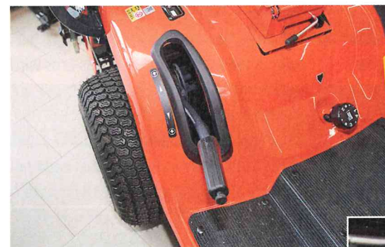
Ist beim GR 1600 II das Ausheben des Mähdecks auf den letzten Zentimetern schwergängig, liegt oft ein Einstellfehler vor.
