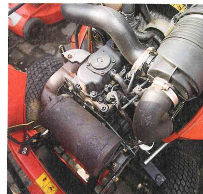
Respekt: Auch nach 3420 Betriebsstunden läuft dieser Zweizylinder-Diesel problemlos. Fotos: Tovornik, Zäh
