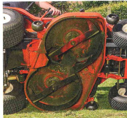
Die Mähmesser sind beim GR 1600 II versetzt angeordnet. Beim Zusammenstoß mit einem Stein kollidieren die Messer nicht.
