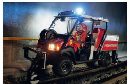
MULE 4010 DT Löschfahrzeug im Bahn-Tunnel
