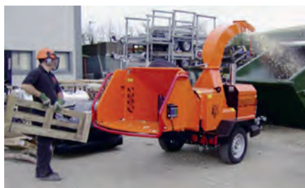
Timberwolf Shredder S426 beim Shreddern von Paletten und Abfallholz.
