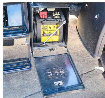
Die ersten Batteriekästen sind noch ohne zusätzliche Dichtung ausgeliefert worden. Prüfen Sie die Kästen auf Korrosion.
