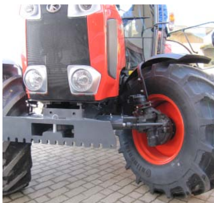
Die spezielle Technik des Kegelradantriebs sorgt für einen einmaligen Lenkeinschlag.
