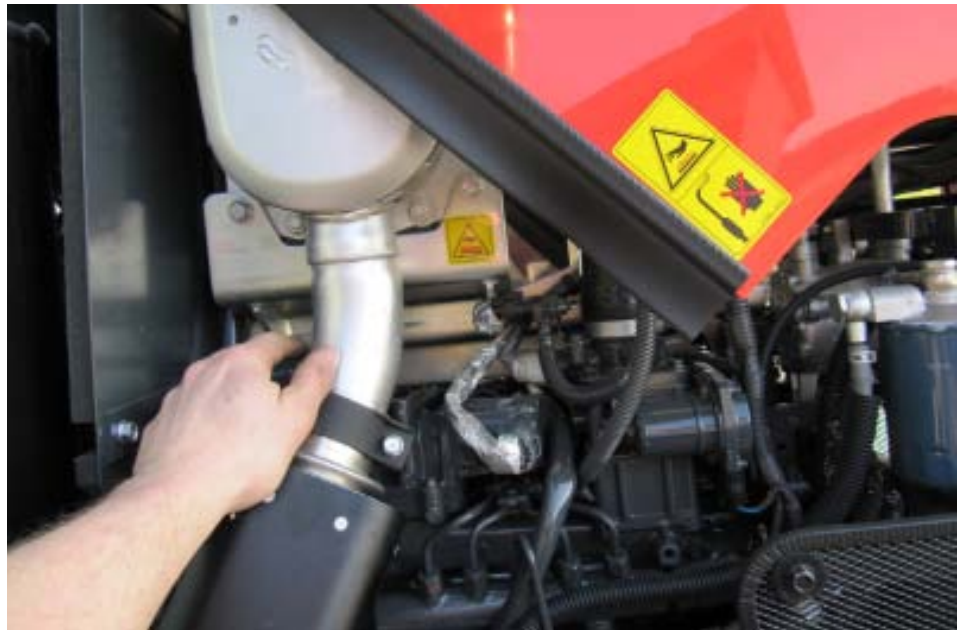
Unter der Motorhaube arbeitet ein Vierzylinder-Common-Rail-Kubota-Motor mit Vierventiltechnik und «zentraler Einspritztechnik».
