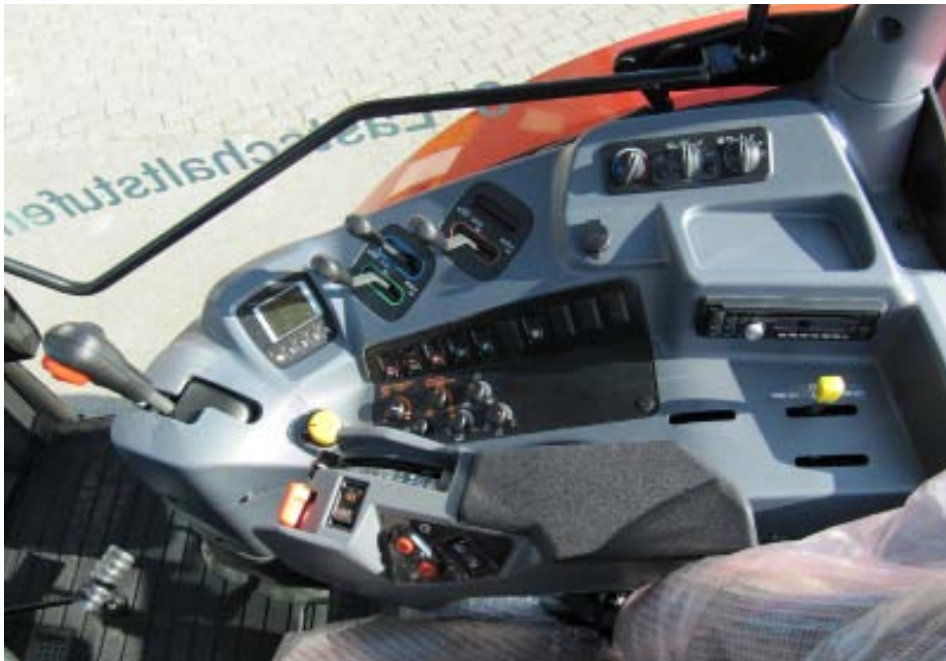
Informationsdisplay und ergonomische Anordnung der Bedienelemente auf der rechten Kabinenseite
