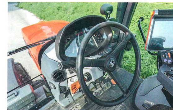
Der Wendeschalthebel ist gut, fehlt nur eine Parkbremse. Und unter der Armatur verstecken sich leider noch etliche Schalter z. B. für Licht und Scheibenwischer.
