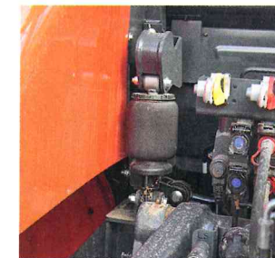
Die pneumatische Kabinenfederung (optional) ist gut.
