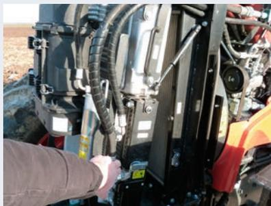
L'intercooler, l'échangeur d'huile hydraulique, le refroidisseur de carburant et le condenseur de climatisation basculent légèrement pour faciliter le nettoyage.
