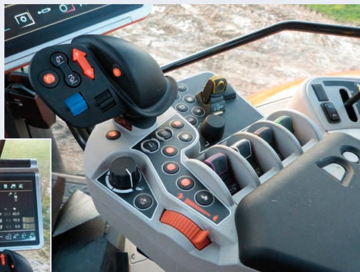
utilisé notamment avec la prise de force, la consigne du régime moteur est transmise par l'accélérateur à main. Le chauffeur sélectionne ensuite l'allure du tracteur à
