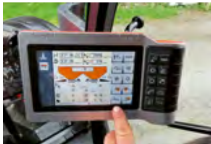
La liaison Isobus à l'épandeur d'engrais a bien fonctionné, ce qui a permis de travailler aisément et avec la fiabilité requise.
