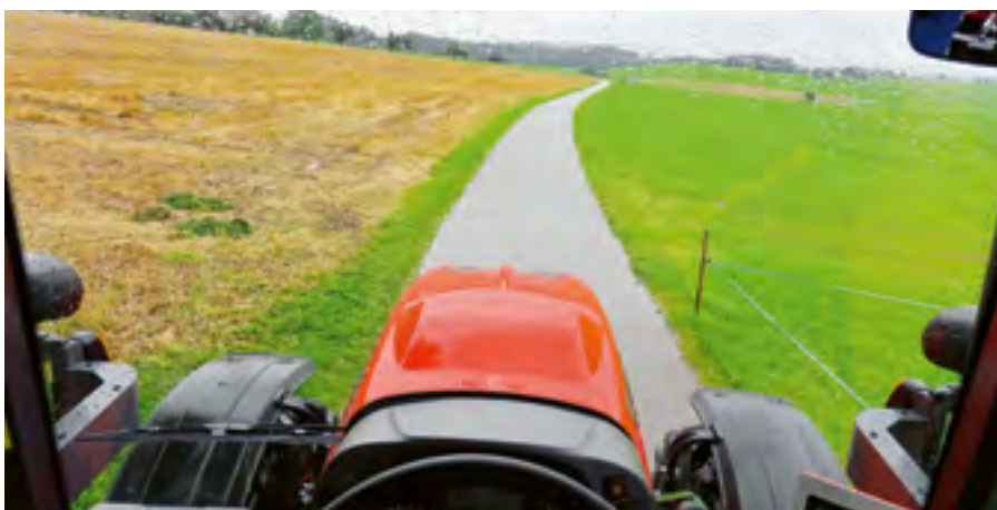
Le capot du compartiment moteur, relativement haut, gêne légèrement la visibilité vers l'avant, mais la cabine à quatre montants bénéficie d'un bon éclairage grâce à son toit vitré et offre une vue panoramique.
