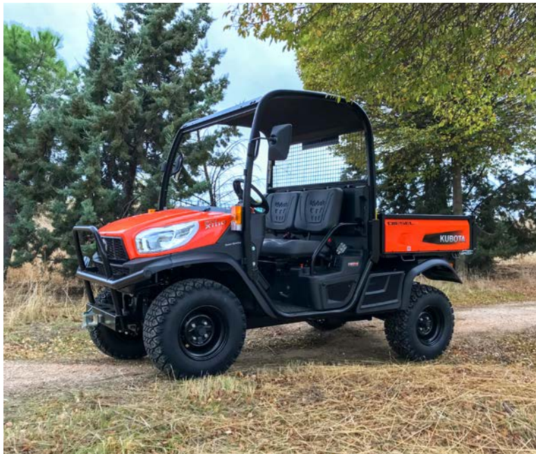
Le RTV X1110 de Kubota avec un puissant frein moteur, un plancher à fond plat et un différentiel à glissement limité sur le pont avant. Photo: Kubota
