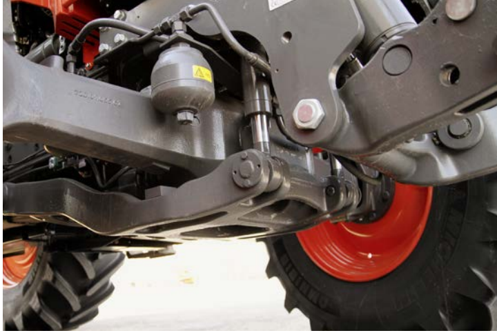
L'essieu avant avec la bielle longitudinale de la suspension provient de Dana.
