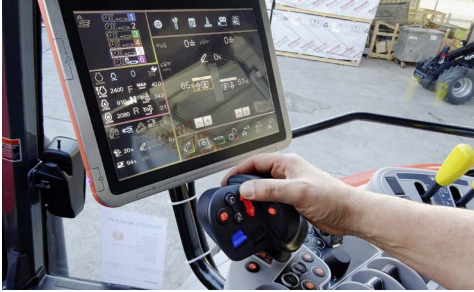
Équipement «Premium» : levier de commande multifonctions intégré à l'accoudoir (fonctions Hydrail et transmission), appareils de commande électriques et écran Isobus.
