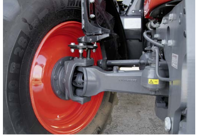
La suspension de l'essieu avant est réglable sur trois niveaux pour s'adapter aux conditions de travail.
