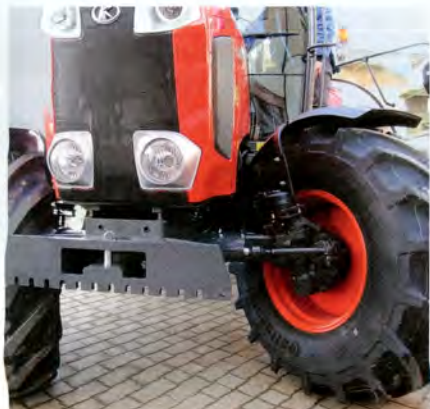
La transmission avant à engrenages coniques permet d'optimiser l'angle de braquage.
