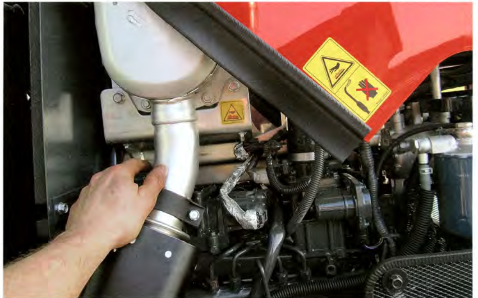
Le capot abrite un moteur Kubota 4-cylindres à 4 soupapes et injection centrale à rampe commune.
