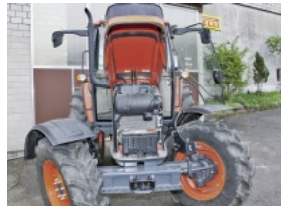
Le moteur est très facilement accessible, et la transmission par pignons coniques de la traction avant permet un braquage impressionnant.
