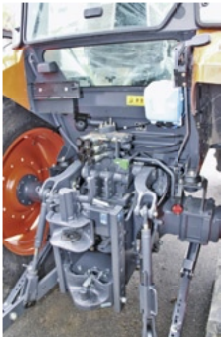
Les prises hydrauliques sont tournées vers la gauche pour faciliter les branchements.
