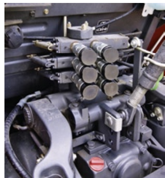
Un détail pratique: Les prises hydrauliques orientées vers la gauche facilitent l'accouplement.
