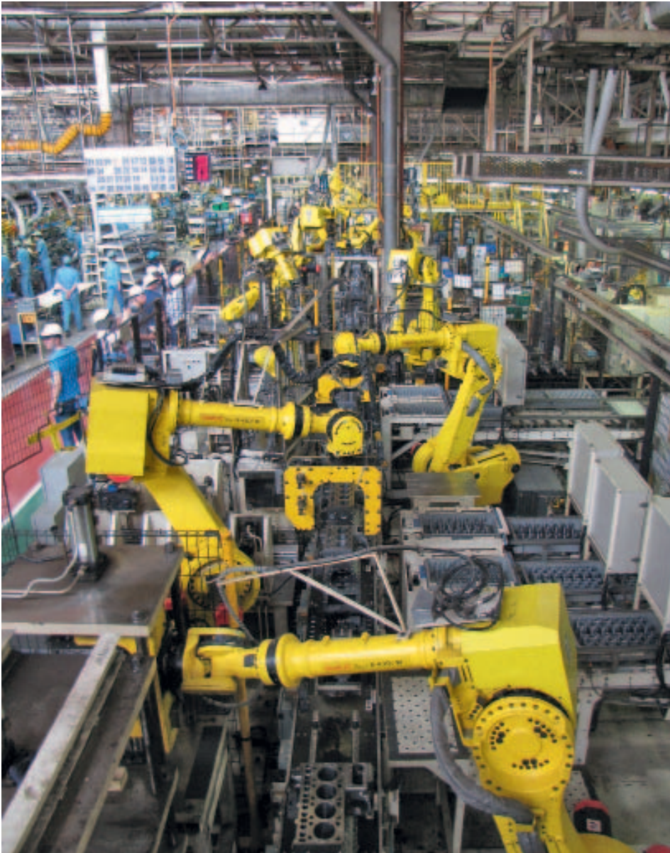
A Tsukuba, 30 robots exécutent le montage des moteurs diesel. (Photos : Ruedi Burkhalter)
