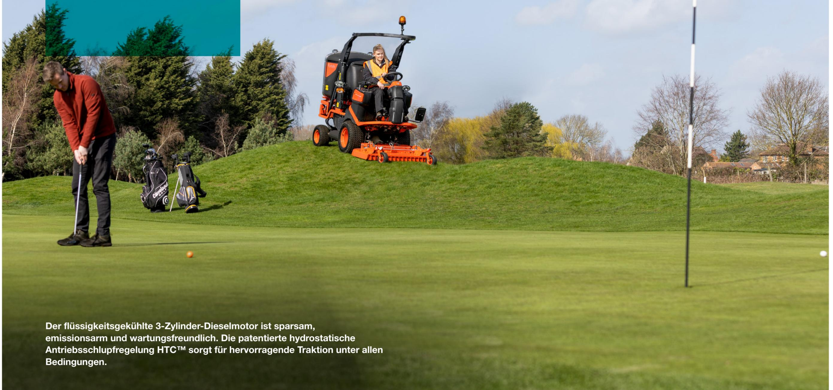
Der flüssigkeitsgekühlte 3-Zylinder-Dieselmotor ist sparsam, emissionsarm und wartungsfreundlich. Die patentierte hydrostatische Antriebsschlupfregelung HTC™ sorgt für hervorragende Traktion unter allen Bedingungen.
