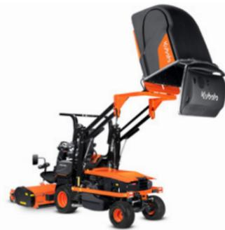
Aushubhöhe liegt bei 2,3 m. Mit dem hydraulisch betätigten Parallelogrammsystem und der großen Kipphöhe entladen Sie den Behälter auf effektive und sichere Weise.
