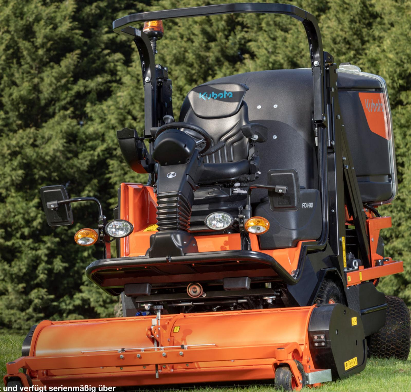
Der Mäher ist für lange Arbeitstage konzipiert und verfügt serienmäßig über einen luftgefederten Komfortsitz. Die schwingungsdämpfende Lagerung der gesamten Fahrerplattform erhöht den Komfort.
