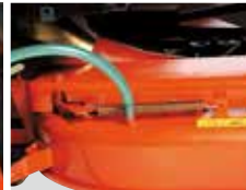
Anschluß für Wasserschlauch zur Mähwerksreinigung.
