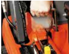
Reinigung des hinteren Teils des Kanals
