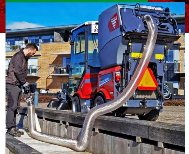
Der 7 Meter lange, flexible Handsaugschlauch ermöglicht es Ihnen überall zu arbeiten. Der Handsauger ist mit einer Staubunterdrückung mit Wasserrückführung ausgestattet.
