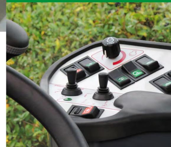
Timan 3330s Bedienpanel ist zusammen mit den Nutzern entwickelt worden, die die Maschine täglich bedienen. Denn volle Kontrolle soll natürlich sein. Tempomat, elektronisches Handgas und Stop-and-Go ist Standardausstattung bei der Maschine.
