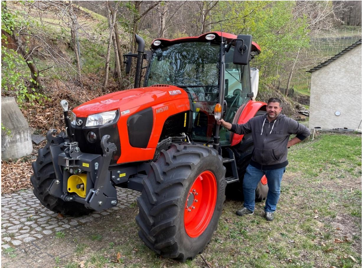
Eckdaten Traktor **Kubota M5111 DTHQ**, 4 Zylinder Kubota Dieselmotor mit Partikelfilter und AdBlue Stufe V, 113 PS, Getriebe 36 V/36 R (6 vollsynchronisierte Gänge, 3 Gruppen und Halbgang), Komfortkabine mit guter Rundumsicht, 3 Steuergeräte mechanisch mit Schwimmstellung und Rasterung, Zapfwelle hinten 540 + 540 Eco, Fronthydraulik und Frontzapfwelle, Bereifung R 540/65R34 & 420/65R24, Gewicht 3'800 kg, Nutzlast 2,7 Tonnen
