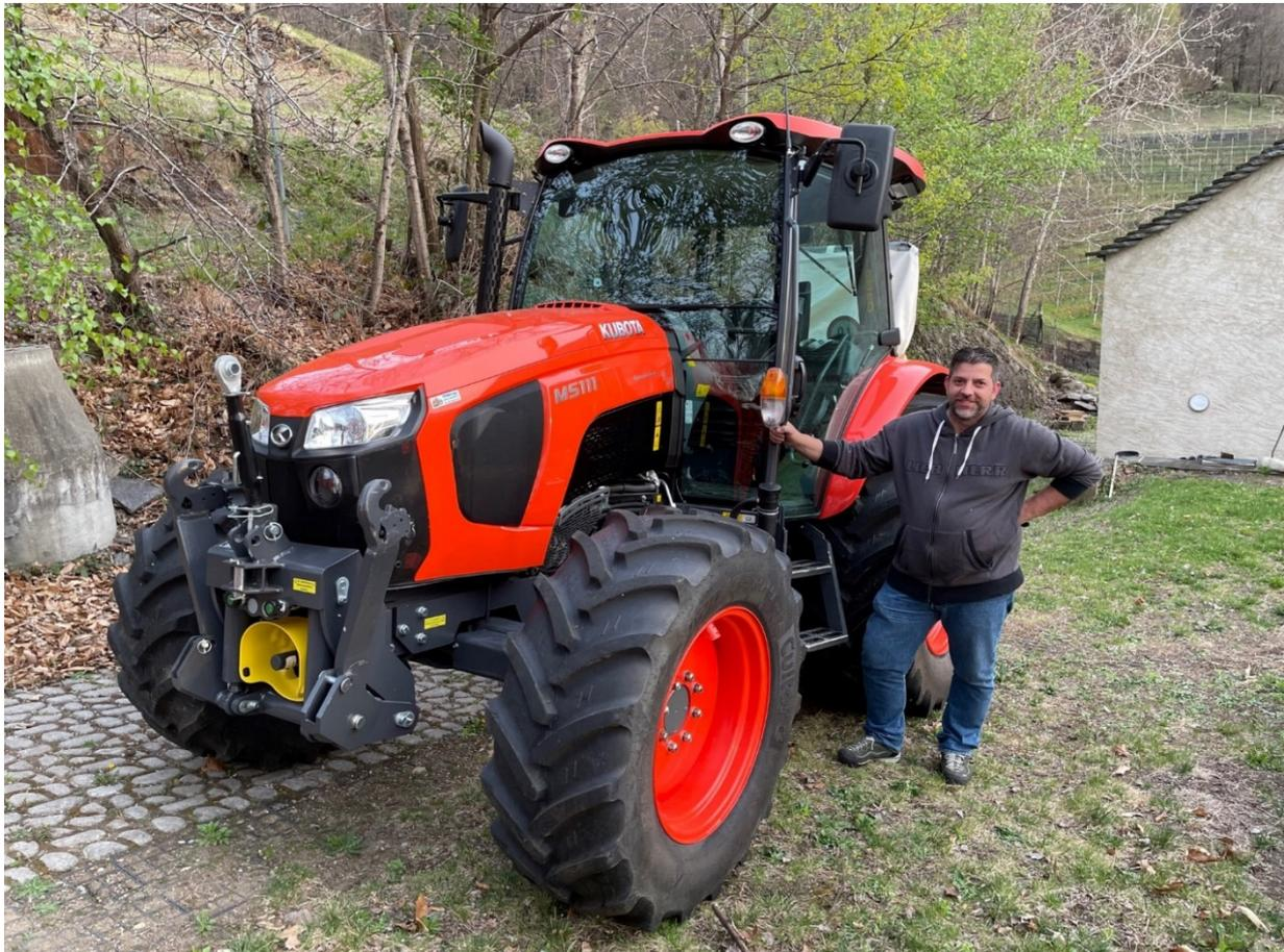
Données clés du Tracteur **Kubota M5111DTHQ**, moteur diesel Kubota 4 cylindres avec filtre à particules et AdBlue Stage V, 113 ch, transmission 36 V/36 R (6 vitesses entièrement synchronisées, 3 groupes et demi-vitesse), cabine confort avec bonne visibilité globale, 3 unités de commande mécaniques avec position flottante et pixellisation, prise de force arrière 540 + 540 Eco, hydraulique avant et prise de force avant, pneus R 540/65R34 & 420/65R24, poids 3'800 kg et charge utile 2,7 tonnes
