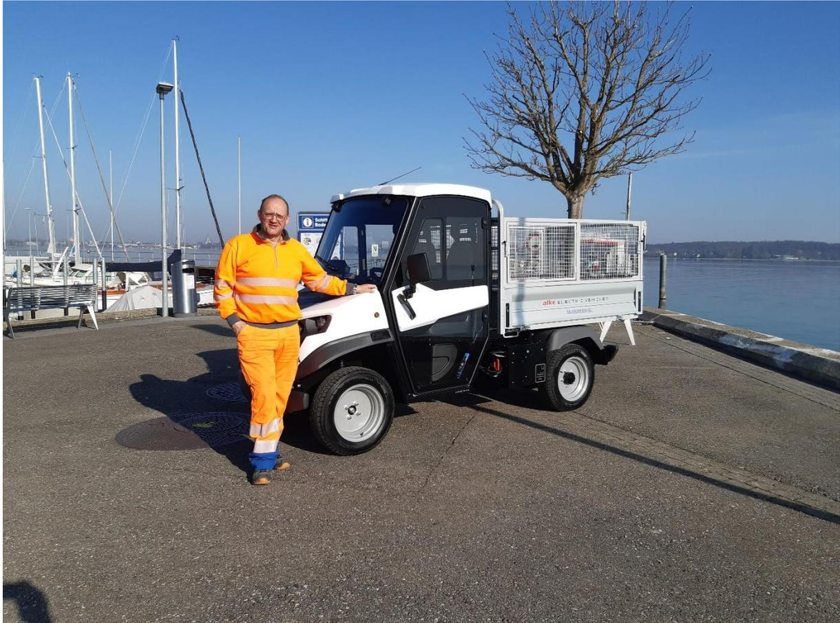
Ein sichtlich zufriedener Werkhofleiter Niklaus Gantenbein mit dem neuen Alkè ATX340E mit Kippbrücke und Gitteraufsatz. Damit auch der Lehrling Strassenfahrten absolvieren darf, wurde die Geschwindigkeit von offiziell 40 auf 30 km/h reduziert.
