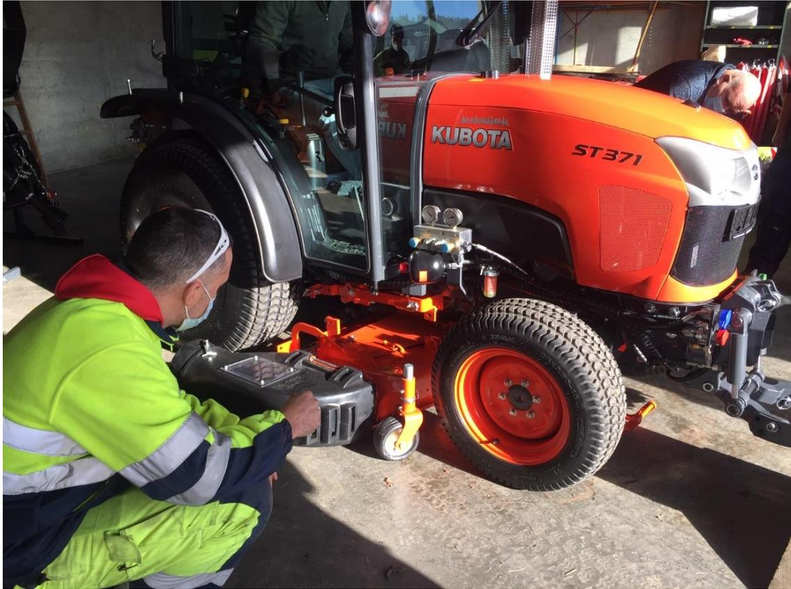
Dans le dépôt, le bac de collecte d'herbe et la tondeuse ont été démontés ensemble pour préparer le tracteur au service hivernal.
