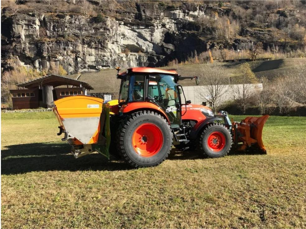
Die hohen garantierten Achslasten und das geringe Eigengewicht beim Kubota M7060DTHQ ermöglichen überhaupt den Anbau dieser schlagkräftigen Anbaugeräte ohne die strengen Gesetzgebungen zu überschreiten.
