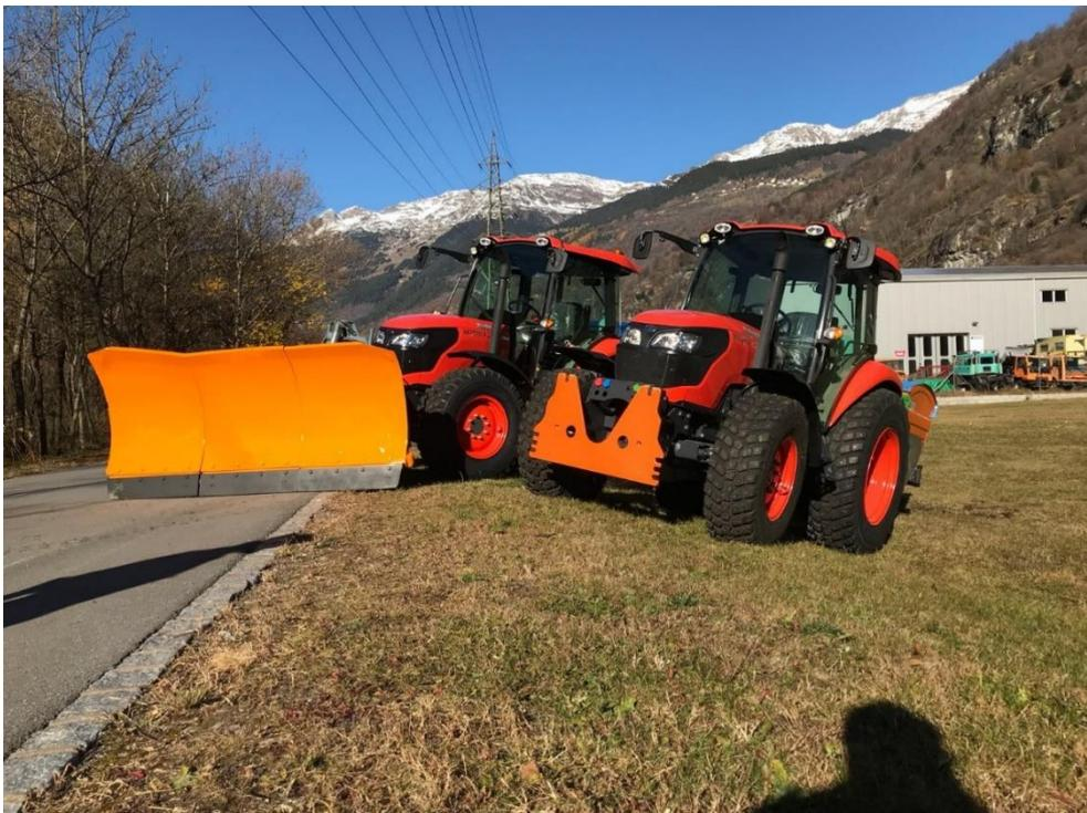
Der Anbau des Schneepfluges mittels VSSA Platte garantiert einen nahen Anbau am Fahrzeug und gute Gewichtsverhältnisse.
