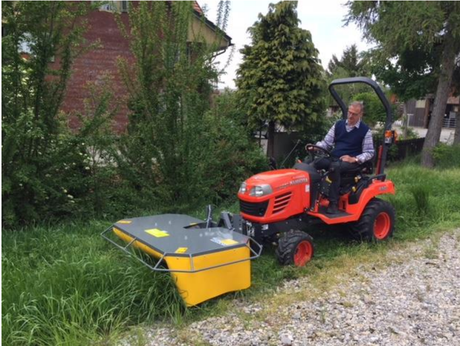
Martin Schwarz beim Test des neuen Bellon Frontmäherwerk mit mechanischem Antrieb über die Frontzapfwelle und einer Schnittbreite von 135cm
