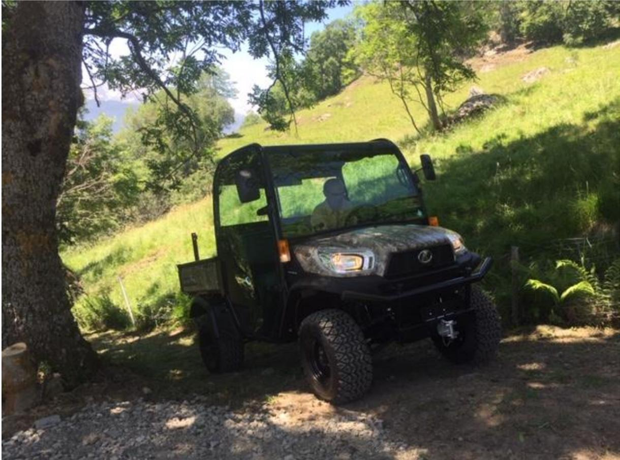
Durch die einfachen Bedienelemente und den hydrostatischen Fahrtrieb, ist die Handhabung schnell erlernt.
