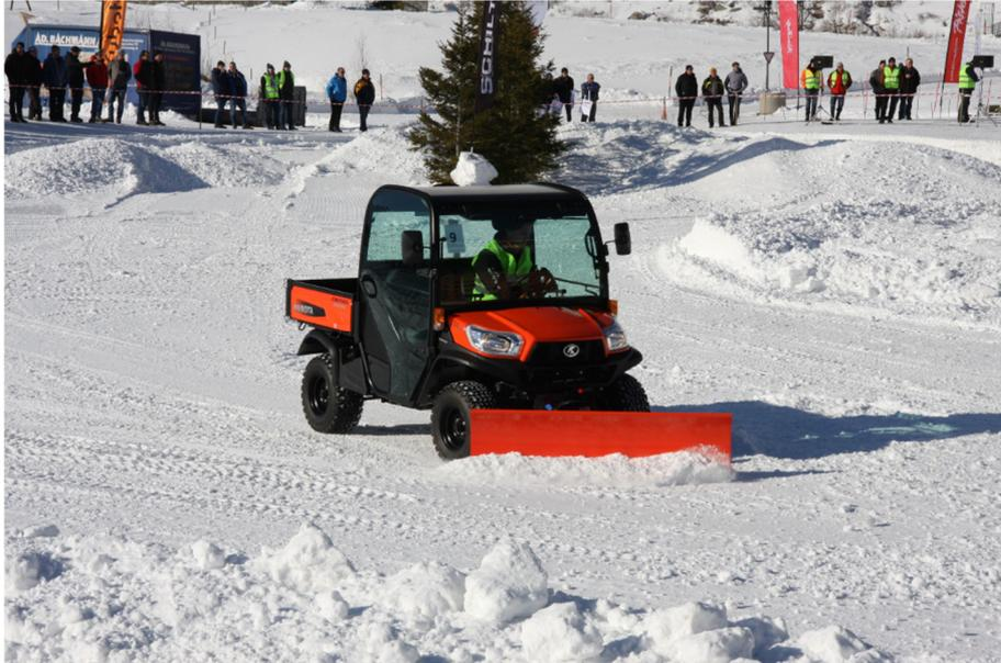
Le Kubota RTV-X1110 est le seul transporter qui a un entraînement hydrostatique. Un aspect sécurité qui profite à l'utilisateur dans toutes les situations. Une lame à neige d'une largeur de 180 cm peut être facilement actionné hydrauliquement en combinaison avec le relevage frontal.
