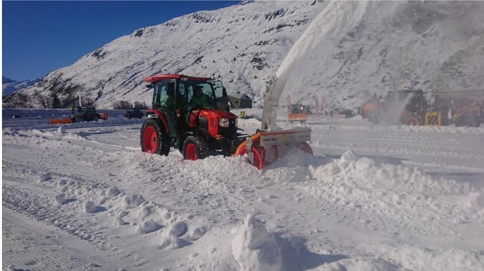
Le Kubota L2602, équipé d'un moteur diesel 4 cylindres Kubota avec turbo et filtre à particules (61 CV), a pu faire fonctionner la fraise à neige Zaugg avec une largeur de 160 cm sans aucun problème.
