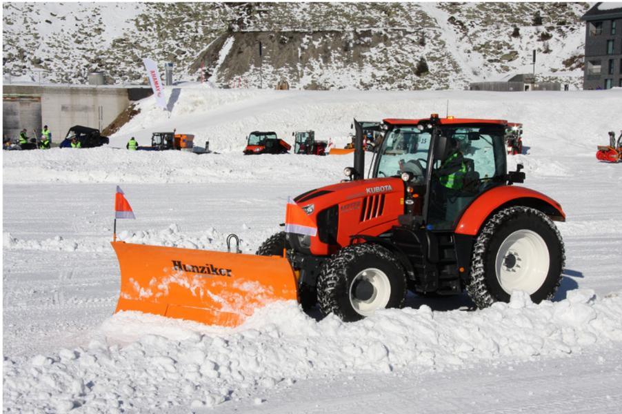
Le tracteur Kubota M7172 KVT est équipé d'un moteur diesel Kubota 4 cylindres de 6'124 cm<sup>3</sup> et 175 CV. La transmission continue combinée à la gestion automatique et à la cabine de luxe confortable et suspendue sont une garantie que le chauffeur peut se concentrer sur les accessoires à tout moment et n'importe où. La conduite est presque automatique, la lame à neige Hunziker de 3 mètres de large s'adapte très bien au tracteur Kubota.
