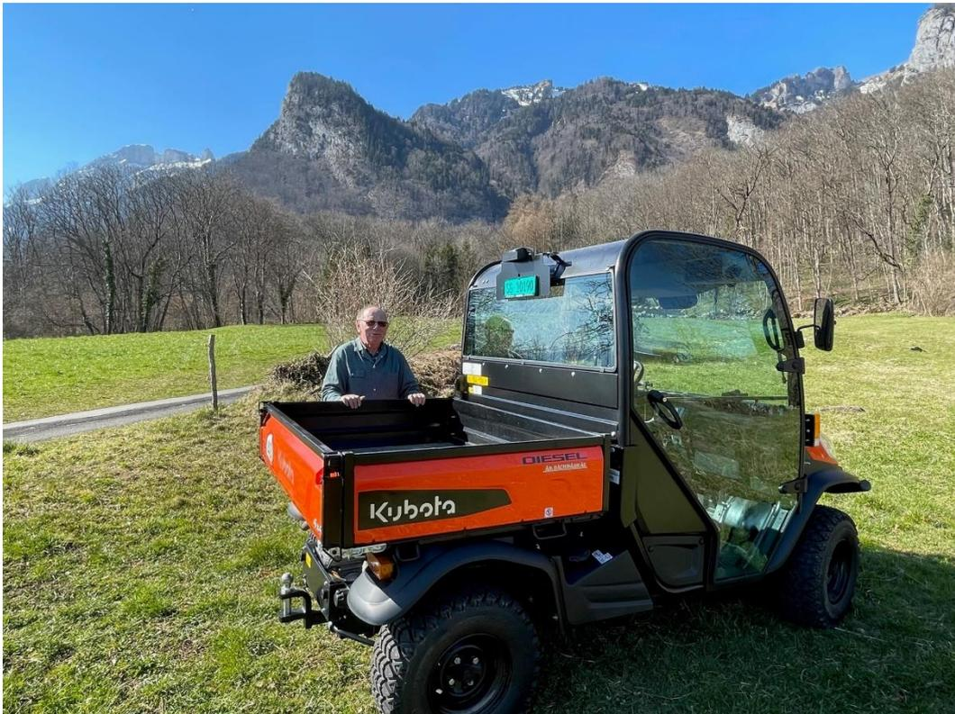
Auf der hydraulisch kippbaren Ladepritsche mit klappbaren Bordwänden können bis zu 500 kg. transportiert werden. Da die Immatrikulation als landwirtschaftlicher Traktor möglich ist, wird ein landwirtschaftliches grünes Nummernschild genehmigt
