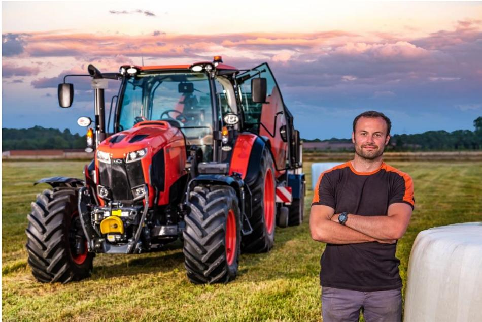
Une maniabilité inégalée est dans l'ADN des tracteurs Kubota et le M6002 ne fait pas exception. L'essieu avant suspendu avec double entraînement par pignon conique et la technologie Bi-Speed de Kubota lui confèrent une maniabilité exceptionnelle avec un rayon de braquage imbattable de seulement 4,5 m.
