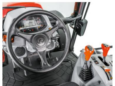
Das handliche Lenkrad können Sie einfach nach vorne neigen, wenn Sie aus der Kabine aussteigen. Zurück auf dem Sitz, bringen Sie es ruckzuck wieder in die ursprüngliche Stellung. Sie müssen dazu nur ein Pedal betätigen. Den Lenkradwinkel hat Kubota optimiert. So haben Sie eine noch bessere Sicht nach vorne und aufs Armaturenbrett.
