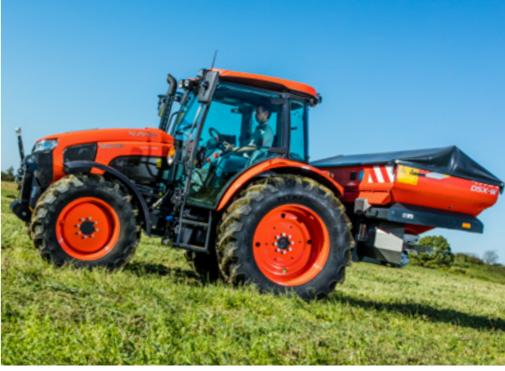
Der M5002 kann mit Nachrüstsätzen zu einem ISOBUS-Traktor nachgerüstet werden, mit dem Sie ohne Einschränkungen jedes am Markt erhältliche ISOBUS-Arbeitsgerät einsetzen können. Das spart Ihnen Zeit und Kosten und lässt Sie entspannt arbeiten.
