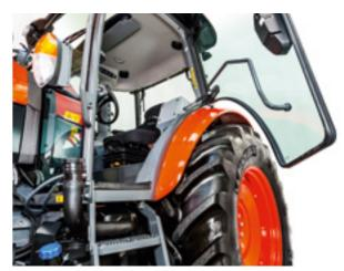
Raumgefühl und eine bessere Sicht in alle Richtungen: Die großzügigen Glasflächen, die schmalen Kabinenposten und die abfallende, elegante Motorhaube tragen dazu ebenso bei, wie der Auspuff seitlich an der Kabine. Dank der vollverglasten Türen können Sie auch die Frontanbaugeräte sehr gut einsehen.
