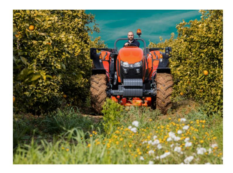
Ein Traktor benötigt oftmals keine Kabine. Hier ist die die ROPS-Version (Überrollschutzbügel) die beste Wahl. Dank seiner ebenen Plattform und dem Verzicht auf Türen ermöglicht dieses Modell nicht nur ein sicheres Fahrgefühl, sondern auch ein beidseitig schnelles Auf- und Absteigen. Ausgestattet mit einer eleketrohydraulischen Wendeschaltung sowie 18 Vorwärts- und Rückwärtsgängen wird das Schalten zum Vergnügen.
