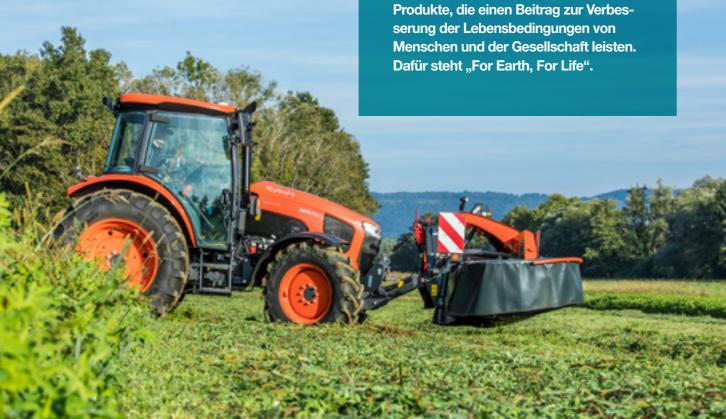
Die Kubota-eigene Vorderachse mit doppeltem Kegelradantrieb ermöglicht einen Lenkeinschlag von bis zu 55°. Dies macht die Maschine extrem wendig.
