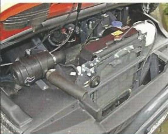
An die Front: Kühler und Luftfilter rücken beim neuen RTV von der Fahrzeugmitte nach Vorn.
