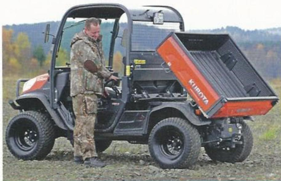
**Easy:** Die hydraulische Kippvorrichtung hebt gut 500 Kilogramm Ladung.
