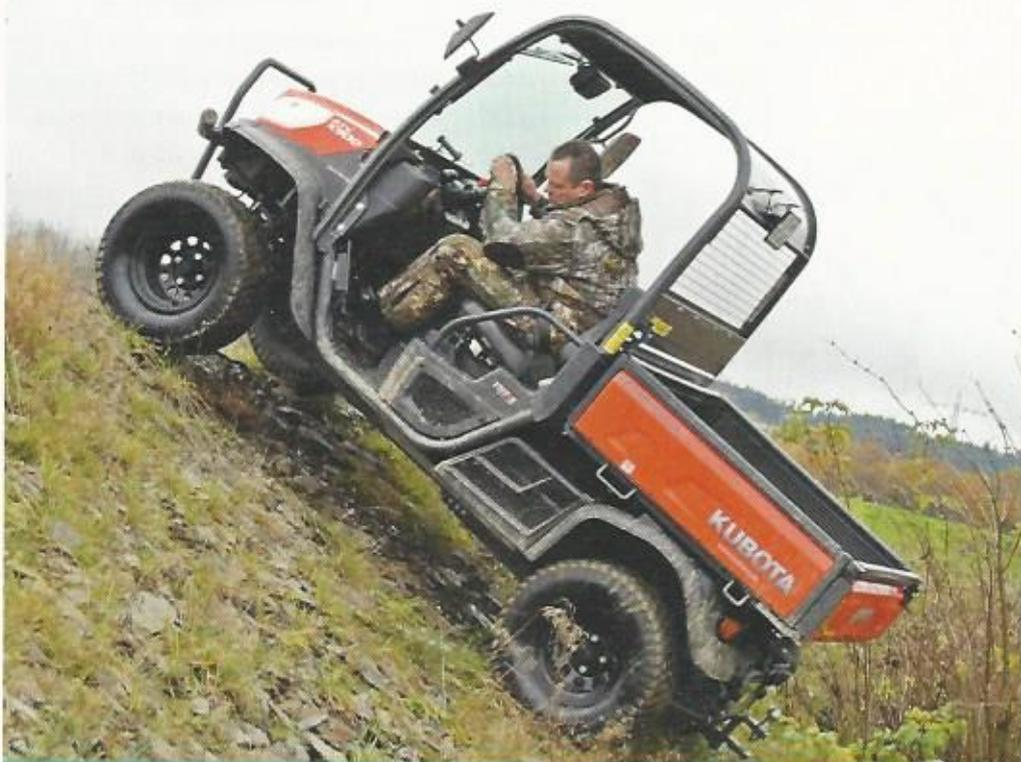
Kein Problem: Der Allradantrieb in Verbindung mit der lastabhängigen Hydrostatik sorgt für ausreichend Traktion.
