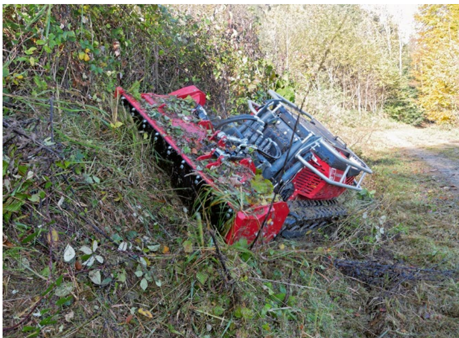
Die Raupe «RC 1000s» von Timan kann Neigungen bis 50° in der Schichtenlinie bewältigen.
